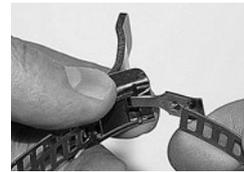
Ouvrir le levier de serrage et adapter l'autre extrémité de la bande à la courbure de la cheville. Introduire ensuite l'extrémité de la bande sous la languette dans la fente de manière à ce qu'elle se trouve au-dessus de la cheville à cliquet.
