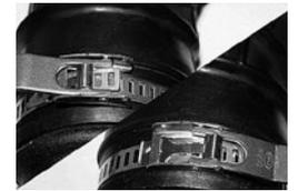
Positionner la bande autour de la pièce. Avec une force minimale, appuyer sur l'extrémité libre et, avec un mouvement de va-et-vient du levier, serrer le collier. Amener le levier en position fermée. L'ergot d'arrêt évite une ouverture inopinée.
