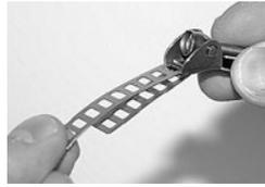
Introduire par le haut l'extrémité de la bande dans la fente du système de fermeture sur environ 30 mm et la plier pour la ramener sous la bande.
