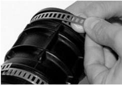
Déterminer la longueur de la bande : par exemple, en l'enveloppant autour de la pièce à serrer et en ajoutant environ 50 mm (longueur de la bande = périmètre + 50mm)
