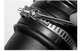
Serrer le collier à l'aide d'un tournevis ou d'une clé à six pans.
