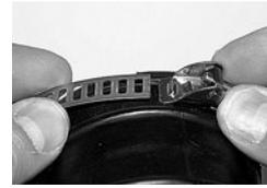
Positionner le collier autour de la pièce. Insérer la deuxième extrémité au-dessus des crochets du système de fermeture. L'extrémité de la bande se trouve ainsi sous le corps de la vis. Engager les crochets dans les perforations dans la position la plus serrée possible.
