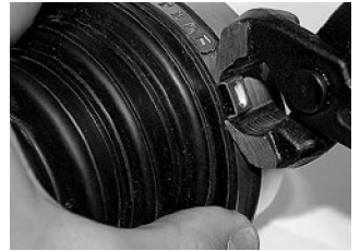
Schritt 4 Klemme über Objekt positio- nieren. Verschluss in kleinst- mögliche Position einhängen. Klemmenohr mit Oetiker Zange richtig schliessen.
