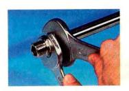
Nach Gutbefund das vormontierte Rohr in den Verschraubungsstutzen einsetzen. Die Überwurfmutter ca. 1/4 - 1/2 Umdrehung über den spürbaren Kraftanstieg anziehen. Der Stutzen muß mit einem Schlüssel gegengehalten werden.
