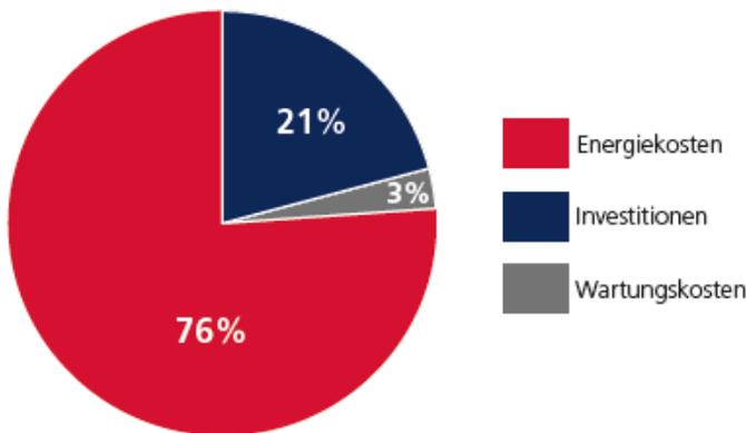
Ein Großteil dieser Kosten entsteht durch Leckagen im Druckluftsystem. Die Luft „entweicht“ ungenutzt. Der Energieaufwand zum Ausgleich der dadurch entstehenden Druckluftverluste ist beträchtlich.
