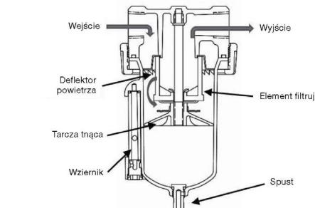
Po uruchomieniu należy regularnie przeprowadzać kontrolę i konserwację. Jeżeli gromadzi się kondensat, należy regularnie w krótkich odstępach czasu spuszczać kondensat poprzez śrubę spustową kondensatu. Okresy konserwacyjne są zależne od rodzaju eksploatacji filtra, jednakże nie mogą być krótsze niż 6 miesięcy.
