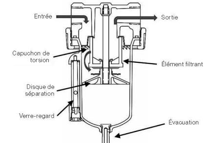
Après la mise en service, une inspection et une maintenance doivent être réalisées régulièrement. En cas d'apparition de condensation, purger régulièrement à brefs intervalles l'eau de condensation au niveau de la vis de purge de condensé. Les intervalles de maintenance dépendent du mode opératoire du filtre de pression mais doivent être réalisés au moins tous les 6 mois.
