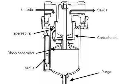
Después de la puesta en servicio, se debe realizar periódicamente su inspección y mantenimiento. Si se genera condensación, descargar regularmente el condensado a través del tornillo de purga de condensado. Los intervalos de mantenimiento dependen del modo de funcionamiento del filtro, sin embargo, se deben realizar cada 6 meses como máximo.
