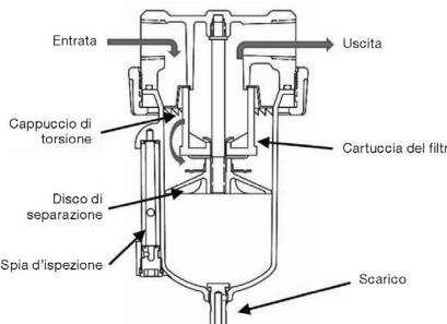
Dopo la messa in funzione, effettuare regolarmente ispezione e manutenzione. In caso di formazione di condensa, scaricare a intervalli regolari la condensa tramite la vite di scarico del condensato. Gli intervalli di manutenzione dipendono dal modo di utilizzo del filtro, ma devono essere eseguiti al più tardi ogni 6 mesi.
