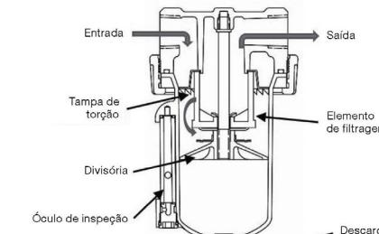
Após a colocação em funcionamento, é necessário realizar regularmente uma inspeção e manutenção. Caso seja formada condensação, purgue-a frequentemente com o parafuso de purga de condensação. Os intervalos de manutenção dependem do modo de funcionamento do filtro mas não devem exceder períodos de 6 meses, no máximo.
