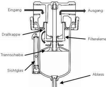
Nach der Inbetriebnahme muss regelmäßig eine Inspektion und Wartung durchgeführt werden. Bei Anfall von Kondensat regelmäßigt in kurzen Abständen an der Kondensatablassschraube das Kondensat ablassen. Die Wartungsintervalle sind abhängig von der Betriebsart des Filters, sollten aber spätestens alle 6 Monate erfolgen.
